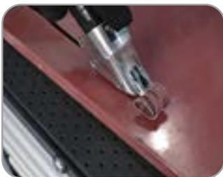
Corta chapas de aço carbono até 1,2 mm e chapas de aço inox até 1,0 mm
